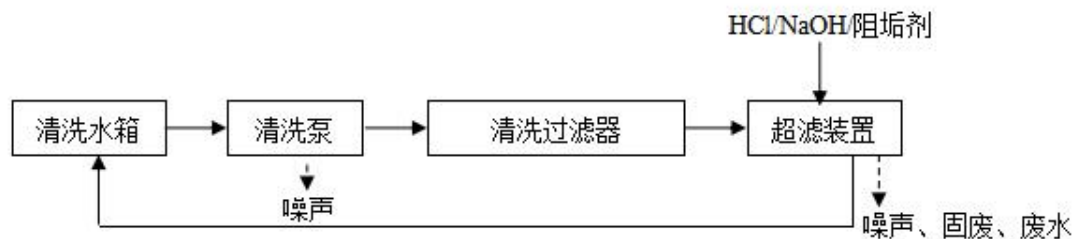
图 3.5-2 超滤清洗系统工艺流程及产污环节图
