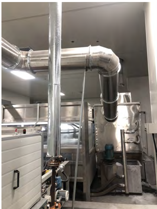
喷涂及烘干设备及配套排气筒
