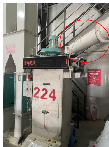
辅料投料工序 废气处理设施进口
